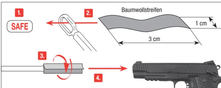
Sichern Sie die Waffe. Nehmen Sie einen ca. 10 cm dicken, langen Stab. Wickeln Sie ein Stück Baumwolltuch um das Ende, benetzen Sie das Tuch mit etwas Waffen-Öl und reinigen Sie damit den Lauf.
