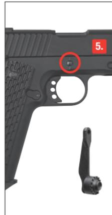
Sur le côté droit de l'arme, pousser et sortir l'arrêtoir de culasse.
