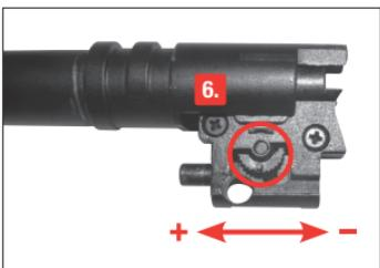
Démonter l'arme, retirer la culasse et régler le shoot-up sur la molette.
