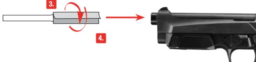
Sichern Sie die Waffe. Nehmen Sie einen ca. 30 cm dicken, langen Stab. Wickeln Sie ein Stück Baumwolltuch um das Ende, benetzen Sie das Tuch mit etwas Waffen-Öl und reinigen Sie damit den Lauf.
