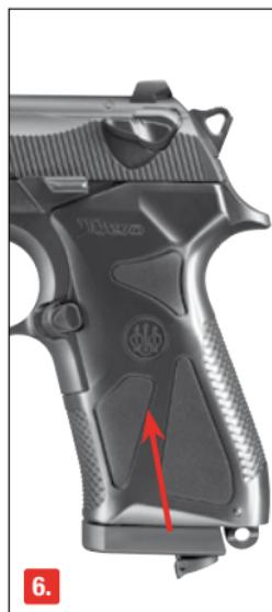
Le chargeur ne peut être retiré que si le chien est désarmé. Appuyez sur l'arrêtoir du chargeur. Retirez le chargeur.
