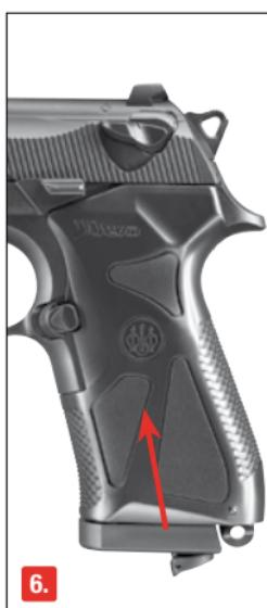
El cargador sólo se puede extraer cuando el martillo está desarmado. Presione el retén del cargador. Extraiga el cargador.
