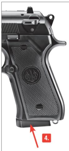
Presione el retén del cargador. Extraiga el cargador.
