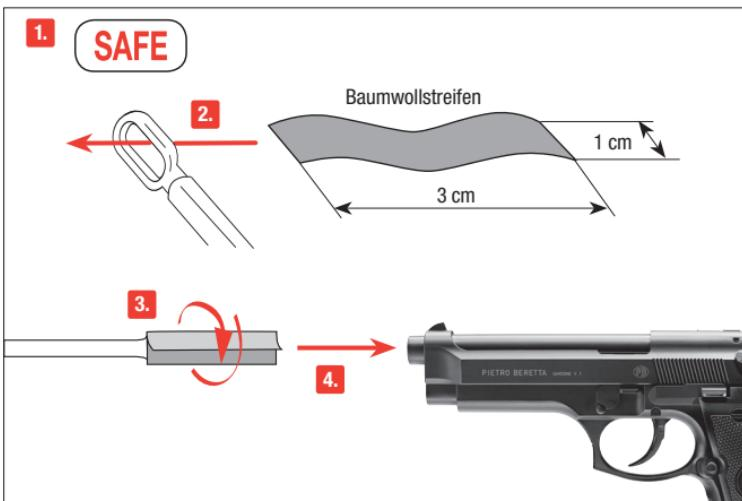
Sichern Sie die Waffe. Nehmen Sie einen ca. 30 cm dicken, langen Stab. Wickeln Sie ein Stück Baumwolltuch um das Ende, benetzen Sie das Tuch mit etwas Waffen-Öl und reinigen Sie damit den Lauf.
