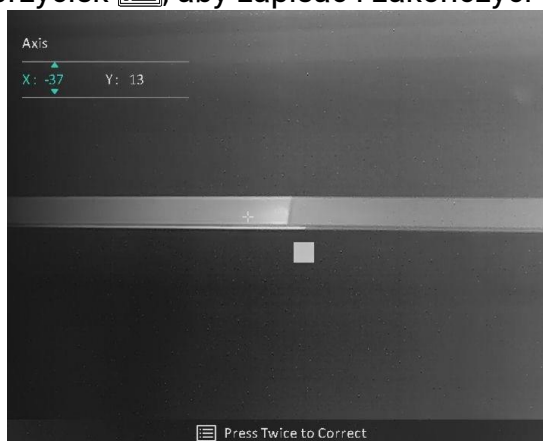
Rysunek 3-4 Korekcja wadliwych pikseli
