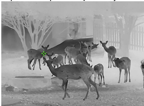
Rysunek 6-1 Śledzenie punktu o najwyższej temperaturze
