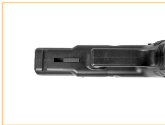
Rys. 2 b) Bezpiecznik na lufie, zabezpieczony.
