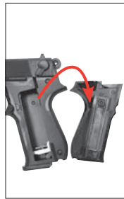
Retirer la plaquette de poignée.
