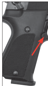
Appuyer sur le bouton de la plaquette de poignée.
