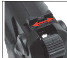
Desplazar lateralmente el alza. Apretar el tornillo.
