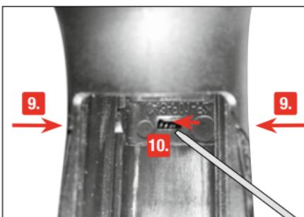
9. Placer le bouton de chargeur dans l'arme tout en maintenant le contre-appui en haut.
