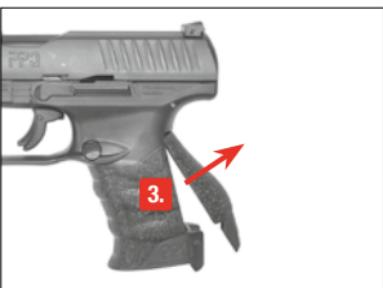
3. Потянуть заднюю часть рукоятки снизу сзади.
