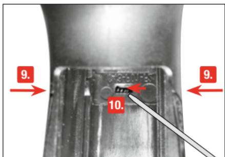
9. Coloque el botón del cargador en el arma mientras sostiene el controsoporte arriba.
