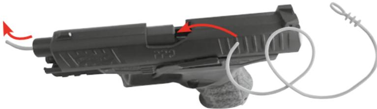
Pociągnąć do tyłu i przytrzymać suwadło. Pociągnąć Squeezy przez lufę. Lufa zostanie wyczyszczona.
