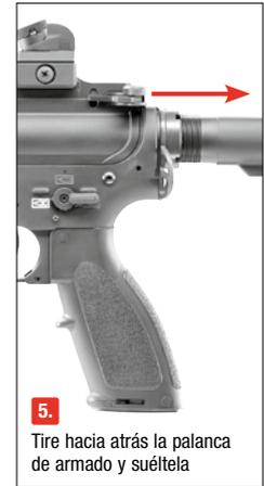
5. Tire hacia atrás la palanca de armado y suéltela
