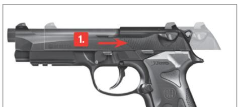
Pour charger l'arme, tirez le levier d'armement vers l'arrière jusqu'à la butée, puis ramenez le vers l'avant.
