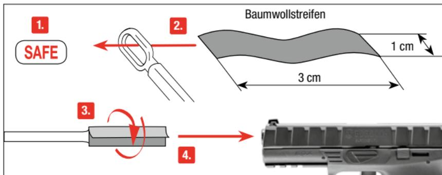
Sichern Sie die Waffe. Nehmen Sie einen ca. 30 cm dünnen, langen Stab. Wickeln Sie ein Stück Baumwolltuch um das Ende, benetzen Sie das Tuch mit etwas Waffen-Öl und reinigen Sie damit den Lauf.
