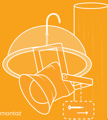
Rys. 1 Sposób montażu osłony przeciwdeszczowej
