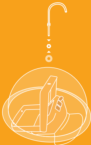
Rys. 1 Sposób montażu osłony przeciwdeszczowej
