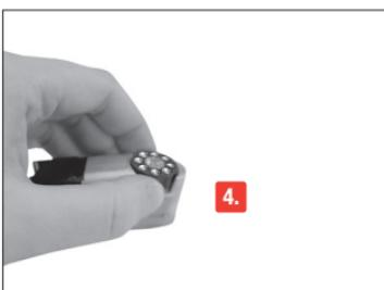
4. Placer le barillet en position de chargement. La couronne dentée est orientée vers le haut.
