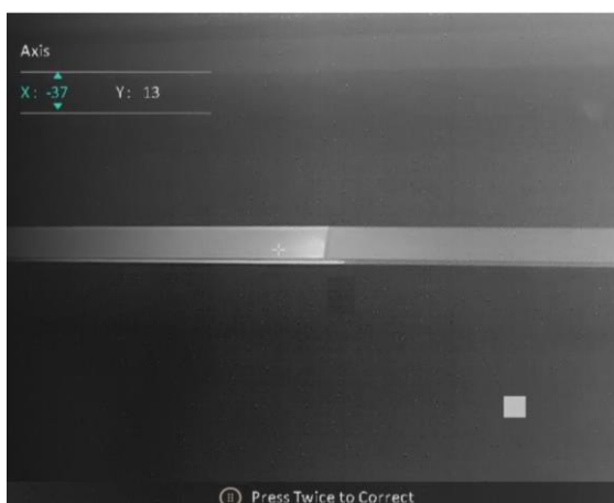
Rysunek 3-6 Korekcja wadliwych pikseli
