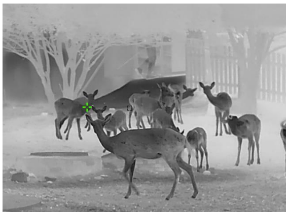
Rysunek 6-2 Śledzenie punktu o najwyższej temperaturze
