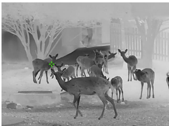
Rysunek 5-2 Śledzenie punktu o najwyższej temperaturze
