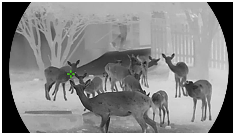
Rysunek 5-2 Śledzenie punktu o najwyższej temperaturze
