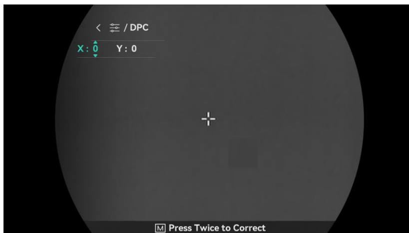
Rysunek 3-6 Korekcja wadliwych pikseli
