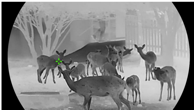
Rysunek 5-2 Śledzenie punktu o najwyższej temperaturze
